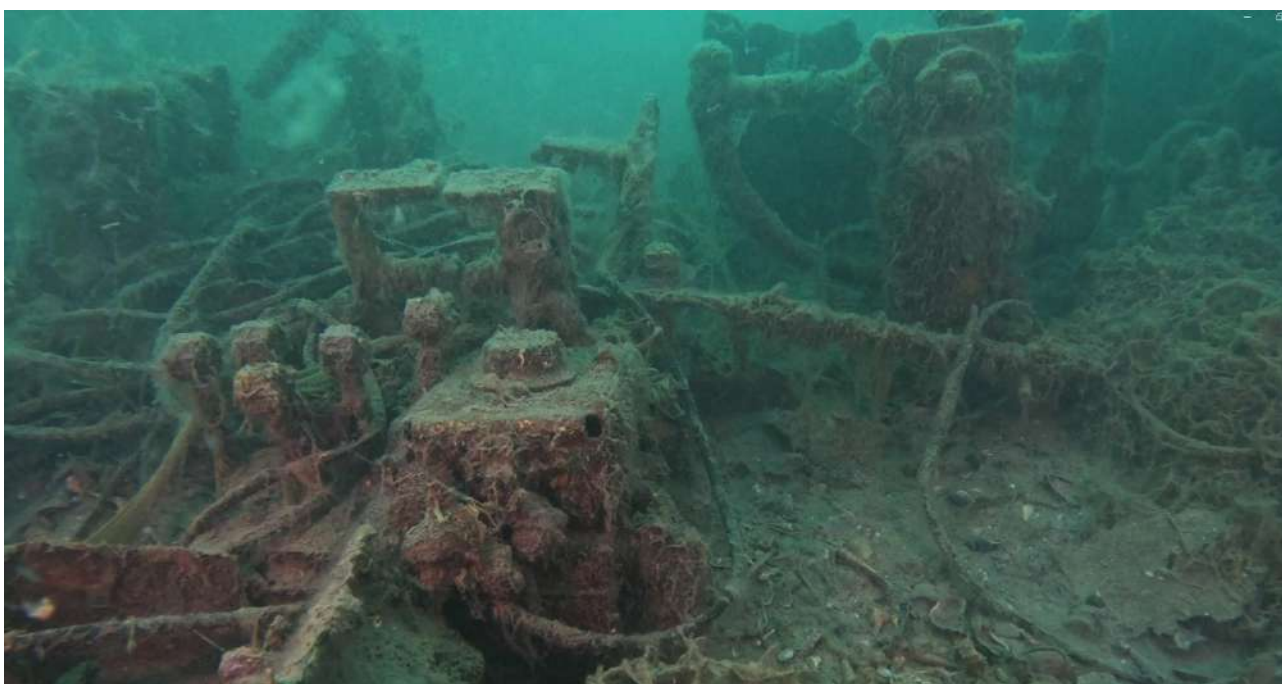
Figura II.II.9 - 5 – Comandi dei motori e delle eliche (elab. G. Bucci da screen shot video GC – Immagine su concessione MiC – SABAP-RA).
