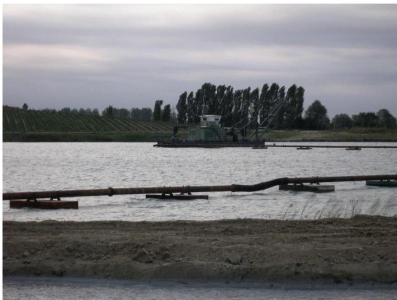
Fig. 4 Settepolesini di Bondeno (Ferrara); la draga che aspira la sabbia del paleoalveo del Po a 30 m di profondità in falda acquifera (archivio privato B. Sala).
