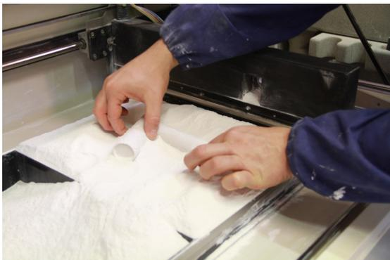
**Fig.3.** Estrazione del pezzo dalla vasca di prototipazione, contenente il materiale di stampa non fissato
