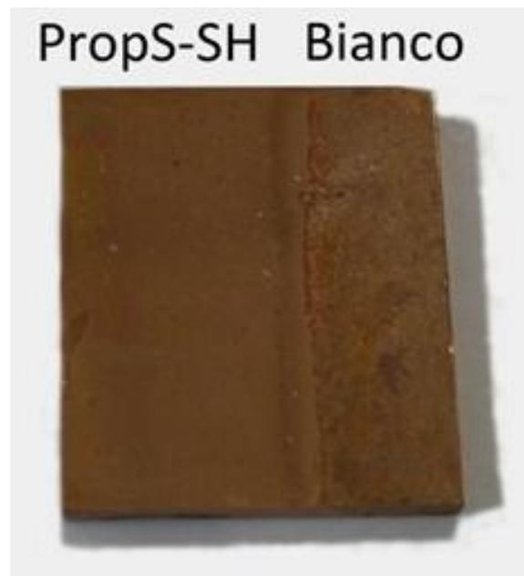
**Fig.7.** Aspetto di un campione di bronzo dopo esposizione a nebbia di pioggia acida, sia in assenza che in presenza di trattamento protettivo a base di PropS-SH.
