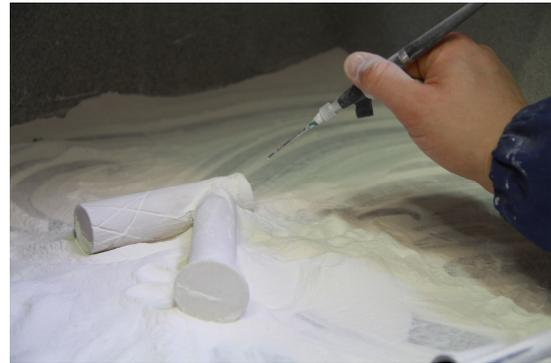
**Fig.4.** Pulitura mediante azione meccanica dolce, praticata mediante soffiatura e spolveratura. Il materiale di stampa è ancora molto fragile.
