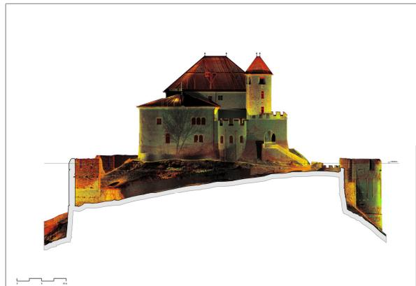
**Fig.5.** Sezione CAD ricavata da nuvola di punti del prospetto Sud.
