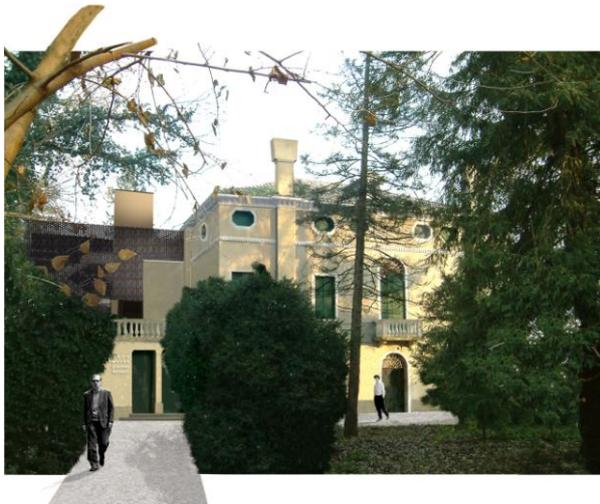
**Fig.5.** Prove di addizione; visualizzazioni tridimensionali. Foglie: rivestimento in lamiera elettrocolorata applicata su rete metallica.
