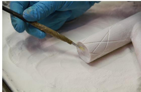
**Fig.5.** Finitura mediante applicazione di resina bicomponente, applicata a pennello, impregnata per capillarità del materiale.
