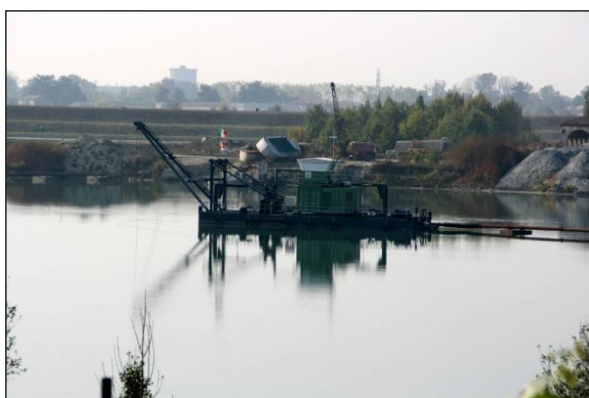
Fig. 1. La draga aspirante in funzione a Settepolesini.
