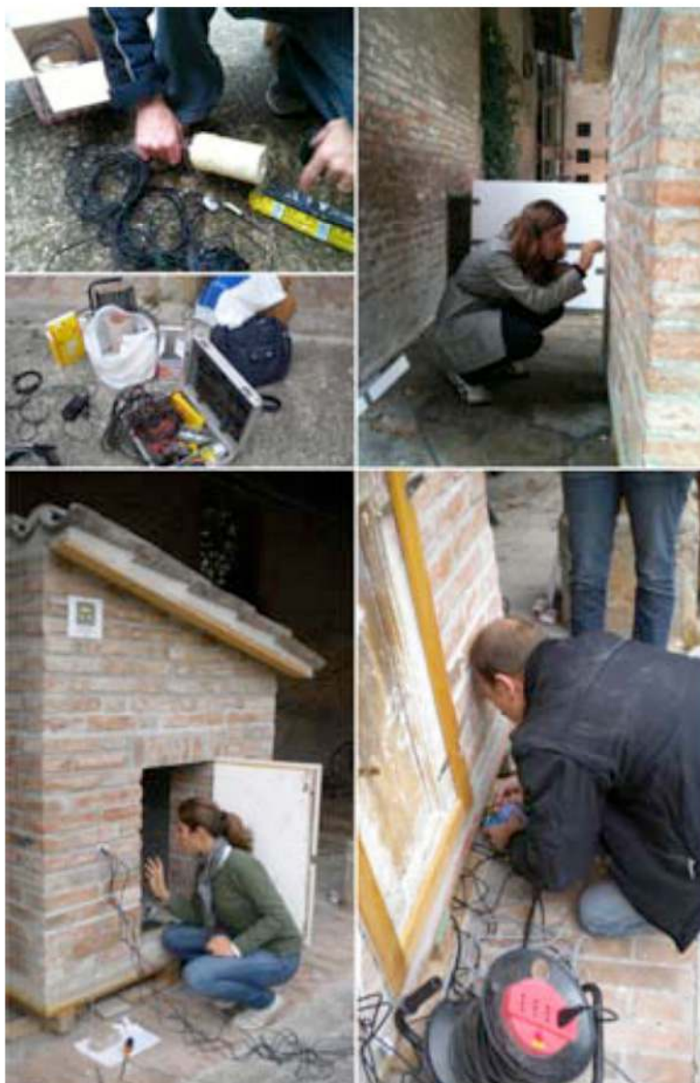
Figura 8.11. Alcune fasi dell'allestimento del test sul modello B. In alto a sinistra è rappresentata parte della strumentazione utilizzata.
