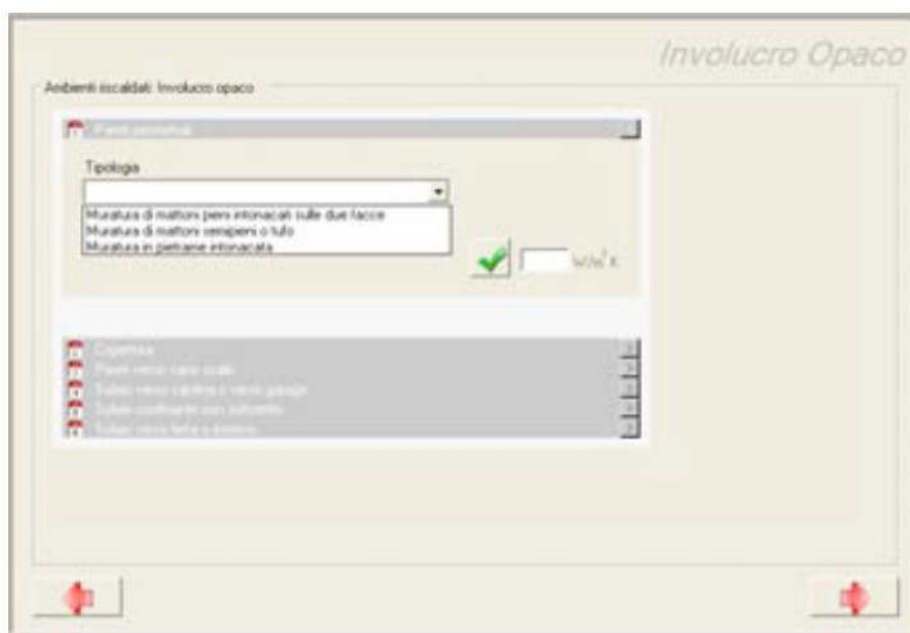
Figura 7.19. L'immagine rappresenta la schermata del software Docet , relativa alla definizione dell'involucro opaco. Come si vede, il programma prevede di selezionare una sola tipologia di muratura fra sole tre possibili, in riferimento agli abachi contenuti nel prospetto A della UNI TS 11300.
