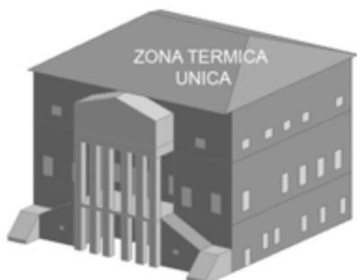
Figura 7.10. Modello tridimensionale dell'edificio. In questo caso la zona termica è unica per l'intero fabbricato.
