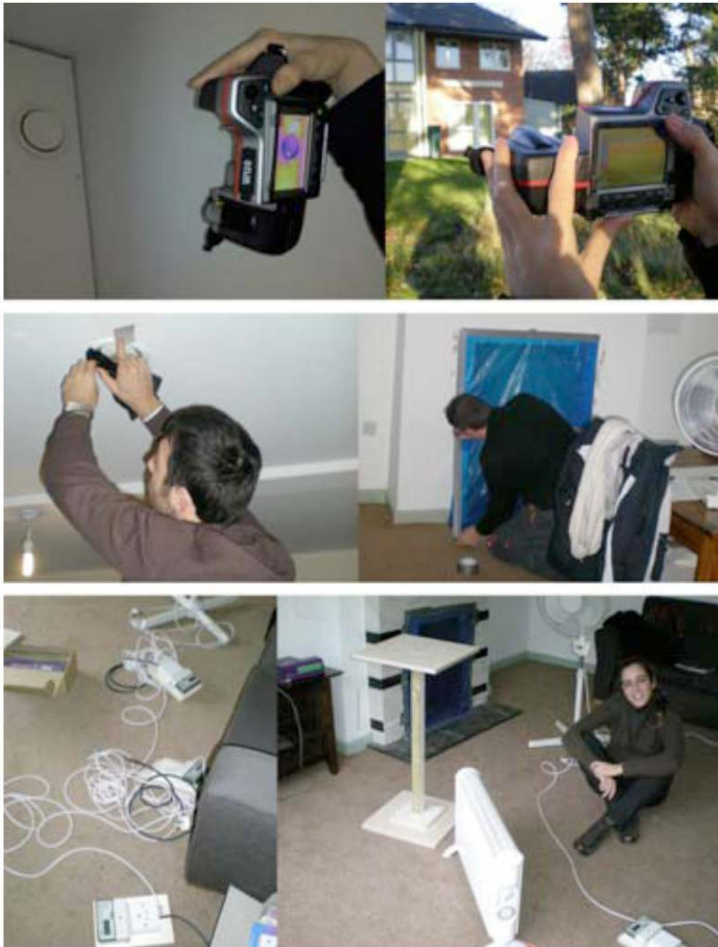
Figura 8.3. Le fasi del coheating test , sperimentato nella EON House nel campus dell'Università di Nottingham. In alto, le analisi termografiche interne (una bocchetta di mandata dell'impianto di ventilazione meccanizzata) ed esterne (fronte Sud); in centro le necessarie operazioni di chiusura delle prese d'aria (una bocchetta di ventilazione e un camino); in basso le fasi di montaggio dell'attrezzatura e un locale della casa pronto per il test.
