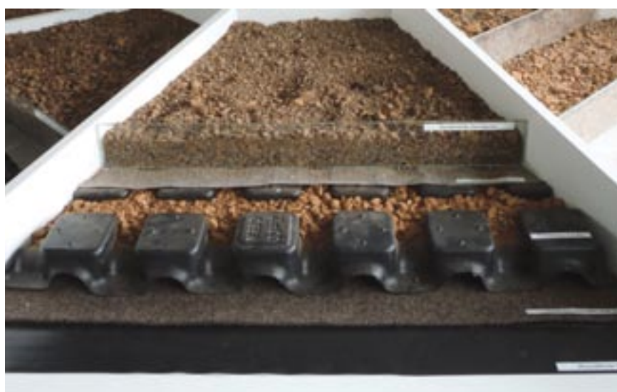
Figura III.7: Combinazione di due elementi di accumulo idrico
