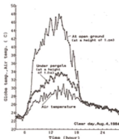
Figure C.1 e C.2: Contenimento delle temperature superficiali dei materiali edilizi
