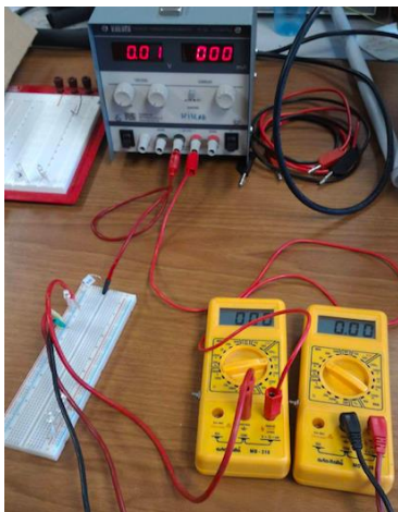
Figura 4 – Apparato sperimentale per misura della costante di Planck con i LED, a destra la curva caratteristica dei LED, corrente ( \mu\text{A} ) e tensione (V).
